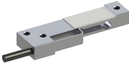
Der Miniatur Kraftsensor KD39 eignet sich mit nur 6mm Höhe und 12mm Breite besonders für die Integration in flachen Messplattformen. In flachen Messplattformen tragen drei Stück KD39 eine Messplatte. Durch die Absätze auf der Ober- und Unterseite des Kraftsensors erfolgt die Montage auf einer ebenen Platte.
