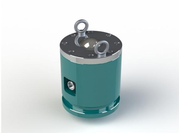
Die Kraftsensoren der Serie KA224 eignen sich für den Einsatz unter rauen Bedingungen. Das robuste Sensorgehäuse kann Querkräfte bis zu 100% der Nennkraft aufnehmen. Die Schutzart ist IP67. Die Einsatztemperatur darf bis zu 120°C betragen. Zum Transport können zwei Ringmutter eingesetzt werden. Der Anschluss erfolgt über einen M23 Steckverbinder in 6-Leitertechnik.
