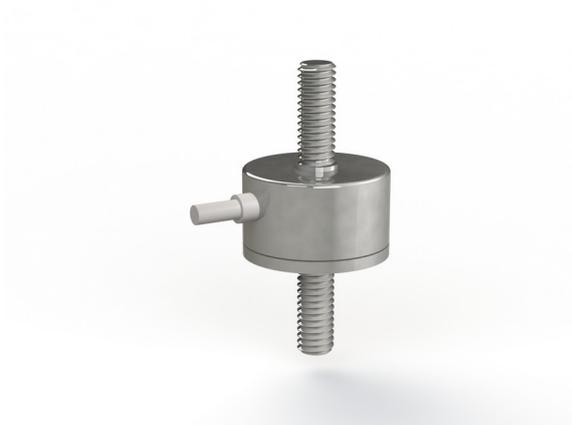
Der KM10z ist ein Membran-Kraftsensor in Ultraminiatur-Ausführung für Zug- und Druckkraft-Messung. Die Krafteinleitung erfolgt über zwei Gewinde M2,5. Bei der Krafteinleitung muss sichergestellt werden, dass keine Biegemomente größer als 0,1 Nm eingeleitet werden.
