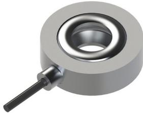
Der Kraftmessring KR20 in Form einer Unterlegscheibe wurde speziell für die Untersuchung von Vorspannkräften an Schrauben entwickelt.
