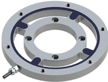
Der Drehmomentsensor besteht aus einem Außenflansch und einem Innenflansch, die über 4 Schubträger miteinander verbunden sind. Außen- und Innenflansch haben jeweils 6 bzw. 4 Gewinde M8 zur Einleitung des Drehmomentes.
