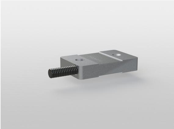
Der Dehnungsaufnehmer DA70 eignet sich zur die Dehnungs- und Kraftmessung an Maschinenelementen in rauher Umgebung. Die Installation erfolgt durch Anschrauben des Aufnehmers mit 2 Schrauben M10 auf einer ebenen Werkstoffoberfläche.
