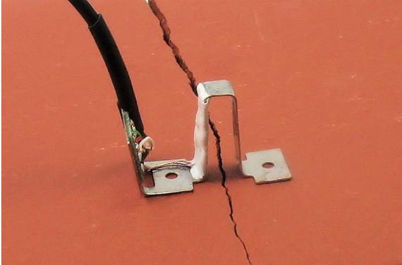
Der Rissensor CS05 in Ultraminiatur Ausführung zeichnet sich durch seine geringen Abmessungen und sein geringes Gewicht aus.
