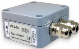
Der Messverstärker GSV-1A eignet sich aufgrund seines kompakten Aluminiumgehäuses in der Schutzart IP66 zur Montage am Einsatzort des Sensors. Durch die hohe Grenzfrequenz bis zu 2,5 kHz eignet er sich zur Erfassung von statischen und dynamischen Signalen von Sensoren mit Dehnungsmessstreifen. Die automatische Nullsetzfunktion speichert die Einstellung im nichtflüchtigen Speicher auch bei Spannungsunterbrechung.
