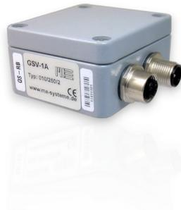
Der Messverstärker GSV-1A eignet sich aufgrund seines kompakten Aluminiumgehäuses in der Schutzart IP66 zur Montage am Einsatzort des Sensors und zur Erfassung von statischen und dynamischen Signalen von Sensoren mit Dehnungsmessstreifen. Die automatische Nullsetzfunktion speichert die Einstellung im nichtflüchtigen Speicher auch bei Spannungsunterbrechung.
