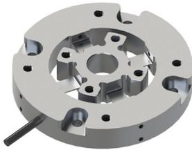
Der Kraftsensor K3R70 eignet sich wegen seiner kompakten Bauform hervorragend für Prüfaufgaben in der Qualitätssicherung sowie in der Werkstoffprüfung. Dieser Präzision-Kraftsensor zeichnet sich aus durch flache Bauweise aus von nur 12 mm Dicke.
