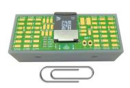
Der GSV-6BT ist ein 6-Kanal Messverstärker mit Bluetooth-Funkverbindung und Datenlogger-Funktion, der bei kleinsten Abmessungen außergewöhnlich viele Features bietet.
