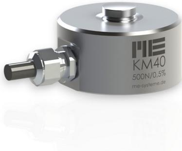
Der Kraftsensor KM40e ist ein Präzisions-Kraftsensor in Membran Bauweise mit integrierter Miniatur-Elektronik zur Messung von Druckkräften. Der Kraftsensor wird mit vier Schrauben M4 auf einer ebenen Fläche befestigt. Für die Krafteinleitung ist eine Kalotte mit Radius 50 mm vorgesehen. Die Krafteinleitung erfolgt mit einer ebenen Platte gegen die Kalotte. Die Härte der Kalotte ist HRC 54. Eine Abplattung der Kalotte ab einer Belastung von ca. 20kN ist daher möglich.
