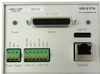
Der 6-Kanal Messverstärker GSV-6ETH ermöglicht den Anschluss von 1-Achsen, sowie 3- und 6-Achsen Sensoren auf Dehnungsmessstreifen-Basis.
