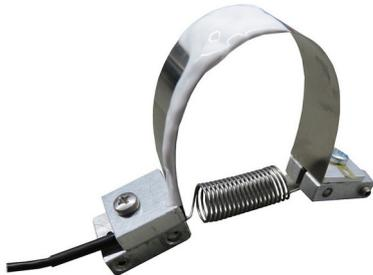
Der Rissensor CS40 wird zur Überwachung von Rissen an Bauwerken eingesetzt. Ein weiteres Einsatzgebiet ist das Dendrometer, für die Messung des Umfangs von Baumstämmen. Der Wegsensor eignet sich zur einachsigen Wegmessung für die Messbereiche von 1mm und 5mm.
