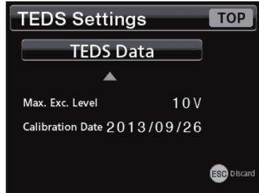
Drücken Sie die Schaltfläche ESC, um den TEDS-Datenanzeigemodus zu verlassen.
