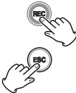
Zur Löschung der zuletzt aufgezeichneten Daten halten Sie bei geöffneter Anzeigewertliste (Indicator value list) die Schaltflächen REC und ESC gleichzeitig gedrückt. Weitere Möglichkeiten zum Löschen von Daten finden Sie unter "11-5 Löschung aufgezeichneter Daten" auf Seite 62.
