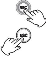
Zur Löschung der zuletzt aufgezeichneten Daten halten Sie bei geöffneter Anzeigewerteliste die Schaltflächen REC und ESC gleichzeitig gedrückt. Weitere Möglichkeiten zum Löschen von Daten finden Sie unter "11-5 Löschung aufgezeichneter Daten" auf Seite 62.
