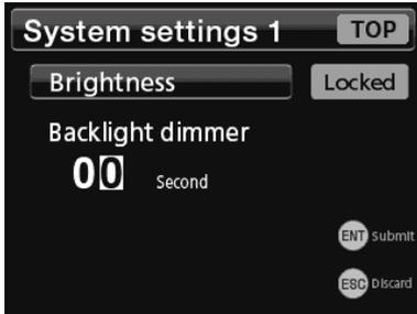
Hier kann die Zeit eingestellt werden, bis die Hintergrundbeleuchtung nach dem letzten Tastendruck gedimmt wird (in 1-Sekunden-Schritten bis zu 60 Sekunden).
