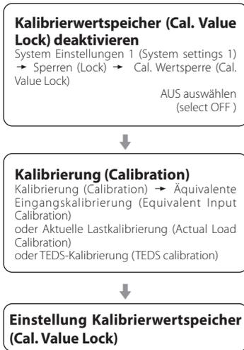
Zunächst werden die Abläufe erläutert, die vor und nach der Kalibrierung durchzuführen sind. Anschließend werden die Abläufe für die äquivalente Eingangskalibrierung, die effektive Last Kalibrierung und die TEDS-Kalibrierung (TEDS calibration) erläutert.
