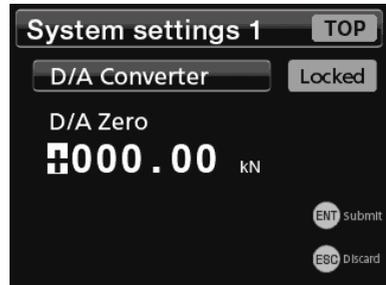
Verwenden Sie die Schaltflächen ◀ und ▶, um die Auswahl zu ändern, und die Schaltflächen ▲ und ▼, um den Wert zu ändern.
