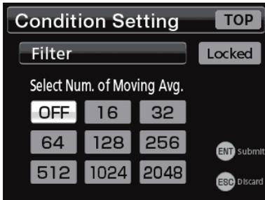
Verwenden Sie die Schaltflächen ◀ und ▶, um die ausgewählte Optionen zu ändern, und drücken Sie die Schaltfläche ENT. Bei Mehrfachauswahlen wird durch Drücken der Schaltfläche ▶, wenn eine Option am rechten Ende einer Zeile ausgewählt ist, die Option am linken Ende der nächsten Zeile ausgewählt.
