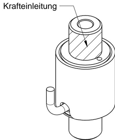
Innenbohrung Ø4,5 ∇ 23 nur in der Ausführung: Nennlast = 2kN
